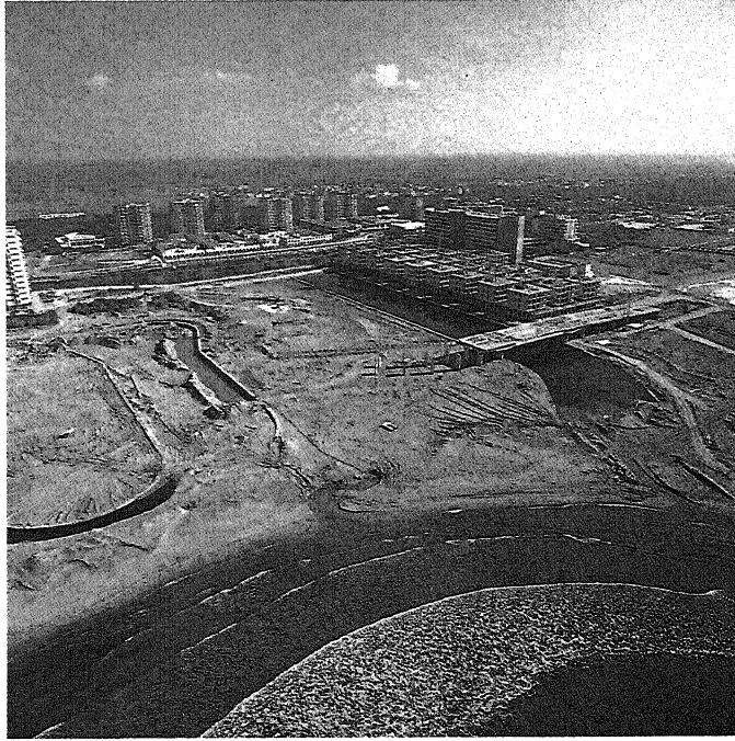
Fig. 3 - Fenomeni di interrimento della nuova darsena a sud del canale di ingresso alla darsena principale; l'area è stata lasciata al più completo degrado. Shoaling processes in the area on the south of the navigation channel of the Pineta Mare marina; note the almost total environmental degradation.
