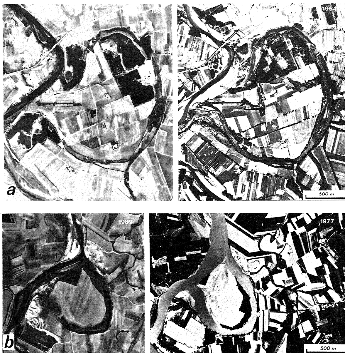
Fig.1 - Evoluzione del percorso fluviale per taglio di meandro (F. Po a monte di Torino). a) Confronto tra fotografie aeree del 1954 e 1989 con deflussi in alveo inferiori al valore medio annuale, riprese dopo 5 e dopo 34 anni dal taglio verificatosi per chute cut-off durante la piena del 4 maggio 1949. (Concessione S.M.A. n° 832 del 16.09.1993). b) Confronto tra fotografie aeree del 1977 e 1989 con deflussi in alveo di piena sezione (1977) e inferiori al valore medio annuale (1989), riprese a due giorni e a 5 anni dal taglio verificatosi per chute cut-off durante la piena del 22 maggio 1977 (Concessioni S.M.A. n°107 del 24 mar. 1980 e n°832 del 16.09.1993).
