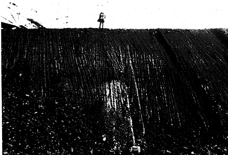
Fig. 6 - Fronte di scavo nella lignite della miniera Poderone. Sono visibili i piani delle fratture immergenti a NW (l'inclinazione visibile è apparente).
