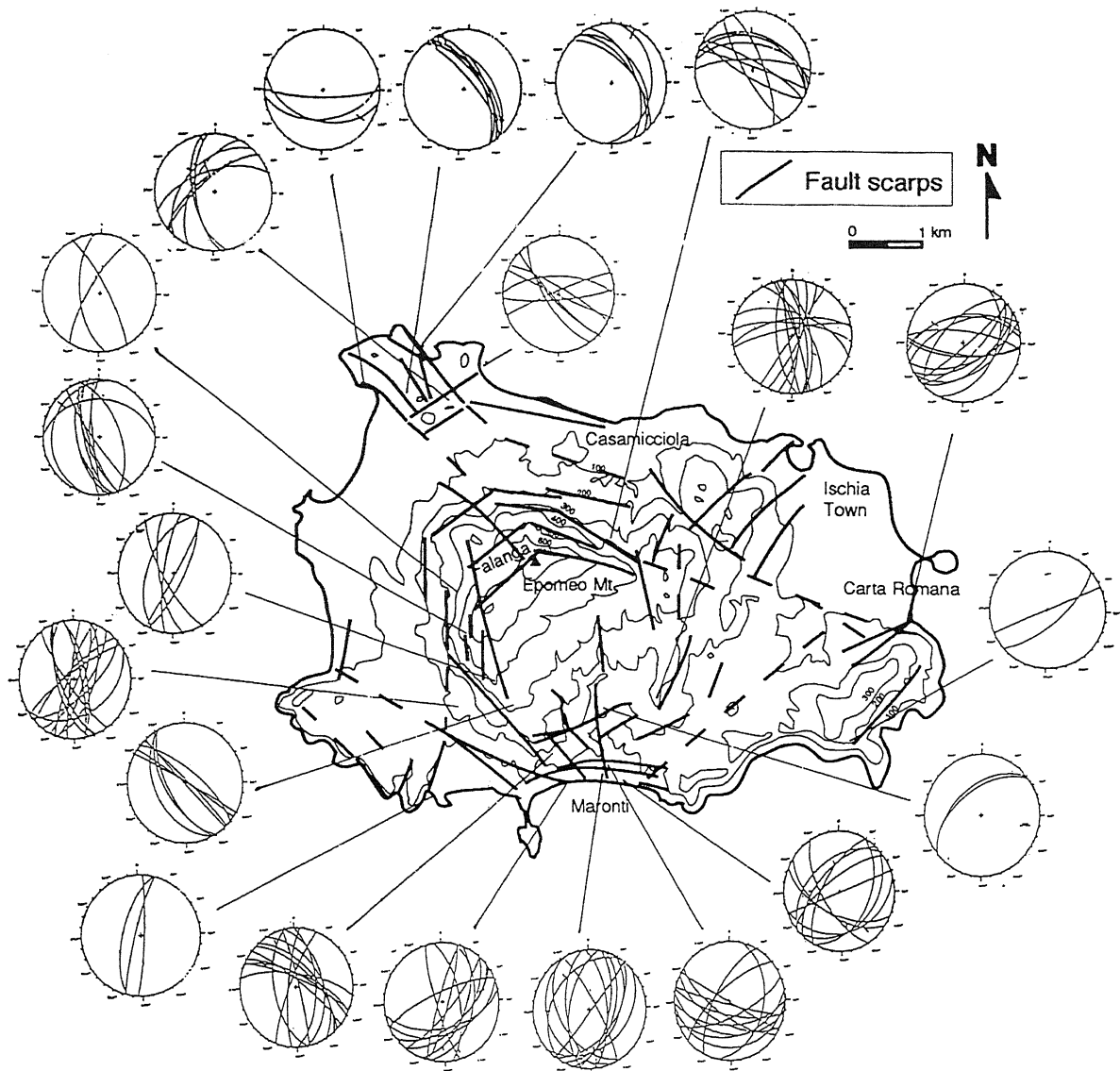
Fig. 2 - Fault scarps identified on the basis of remote sensing data. The most important structural data are subdivided into 21 stations and plotted in Schmidt lower hemisphere nets. Scarpate riconosciute dall'analisi delle foto aeree. Sono inoltre riportati i dati strutturali più significativi, relativi a 21 stazioni di misura, proiettati sull'emisfero equiareale inferiore di Schmidt.
