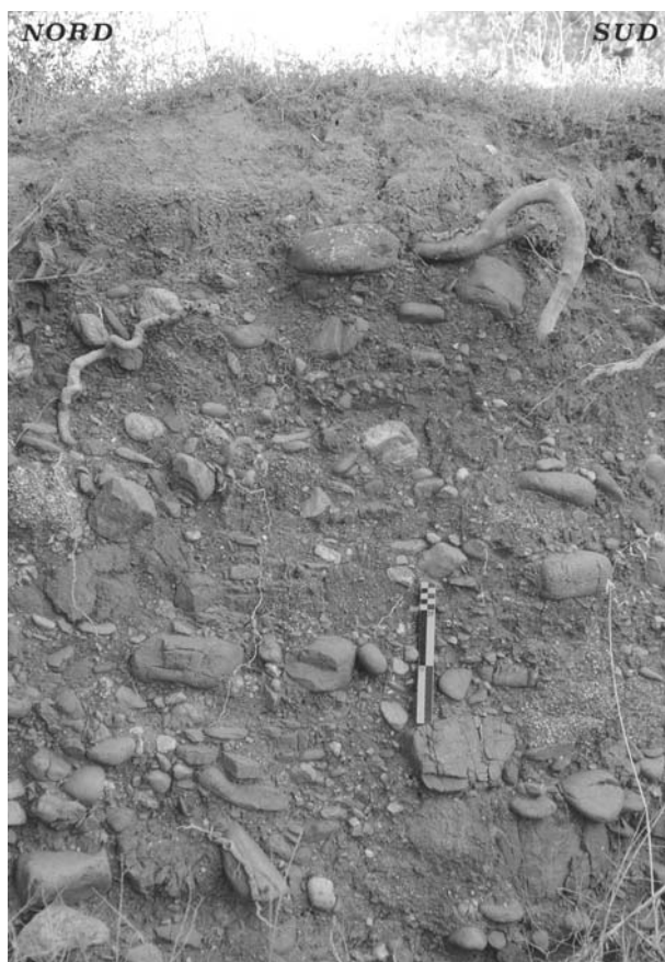
Fig. 27 - Terrazzo del III ordine; Settore 1°; quota 65 m; località Vurdisca; litofacies Cc: deposito rudittico a ciottoli in prevalenza arrotondati, in matrice sabbioso-limoso. L'embriciatura dei ciottoli verso sud (a destra) testimonia l'origine alluvionale del deposito, che costituisce la copertura pedogenizzata dei depositi marini terrazzati.
