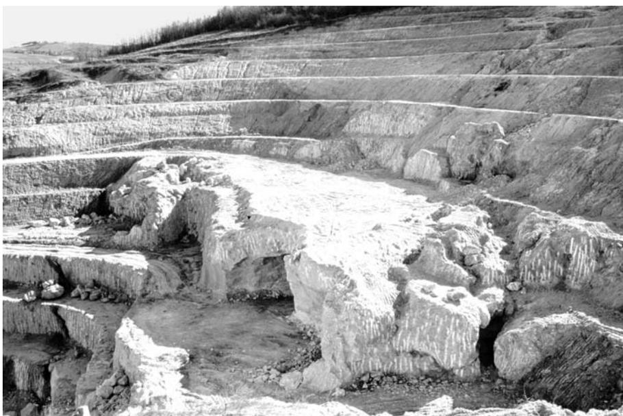
Fig. 5 - Reticolo di condotti carsici ipogei messi in luce lungo i gradoni di coltivazione della cava di Moncucco T.se.
