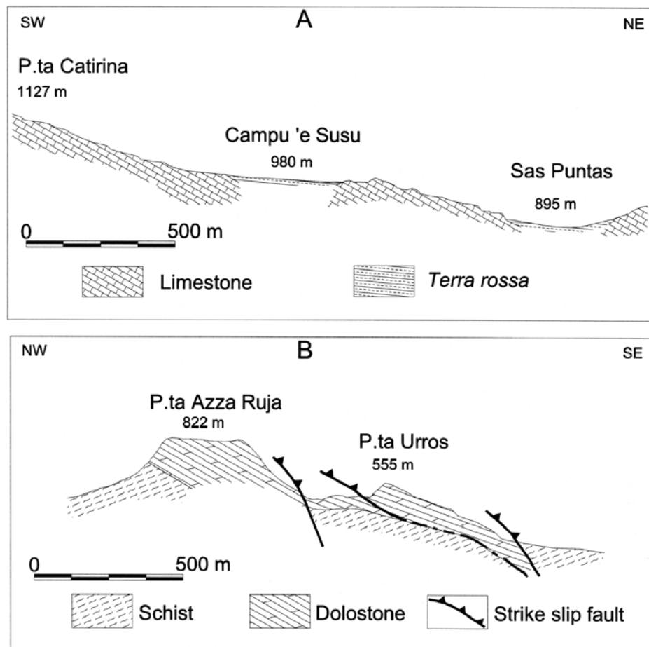
Fig. 2 – Schematic sections showing the structural and geological settings of: A) the two macrodolines Campu 'e Susu and Sas Puntas; B) the two rilievi dolomitici di Punta Azza Ruja e Punta Urros. Per la localizzazione vedasi Fig. 1.
