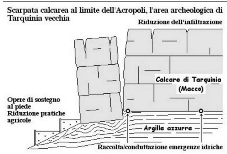
Fig. 14 - Schema delle possibili opere tese a ridurre il rischio idrogeologico nell'area dell'Acropoli.
