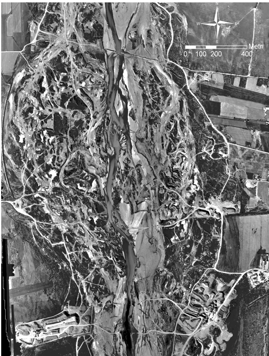
Fig. 9 - Tratto del Fiume Trebbia immediatamente a valle del ponte di Tuna (16 km circa a monte della foce in Po). L'immagine, che si riferisce al volo 1980, mostra quanto sia diffusa e invasiva l'attività estrattiva in alveo.
