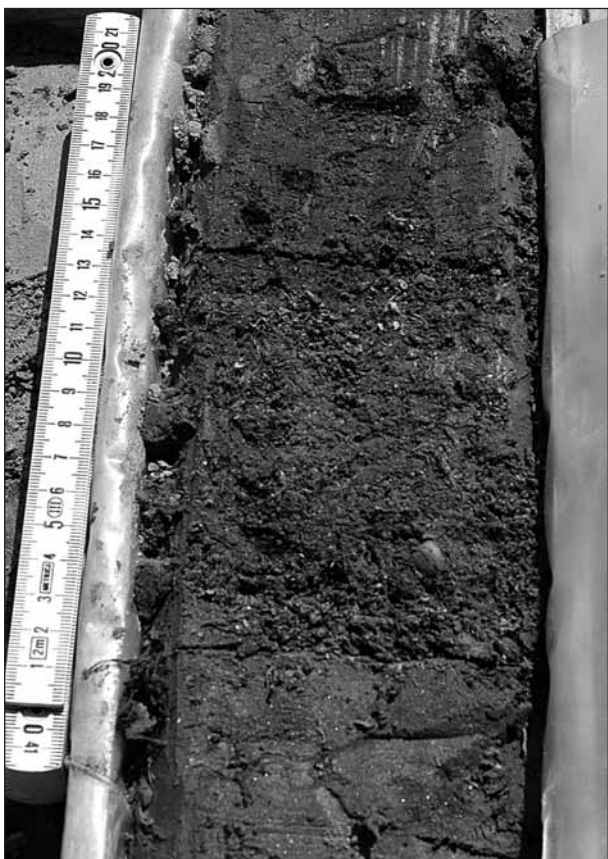
Fig. 10 - In alto è visibile la sedimentazione di retrobarriera, costituita da silt argilloso nerastro, con resti vegetali carboniosi e tritume di conchiglie. Nella parte bassa della foto compaiono silt grigi del sedimento trasgressivo. Nota: la polarità nella colonna stratigrafica è rivolta verso il basso. (Sondaggio SG3 da 15 a 14,75 m circa).
