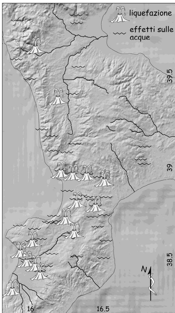
Fig. 10 - Distribuzione dei fenomeni di probabile liquefazione e delle variazioni del regime idrico delle acque sotterranee.
