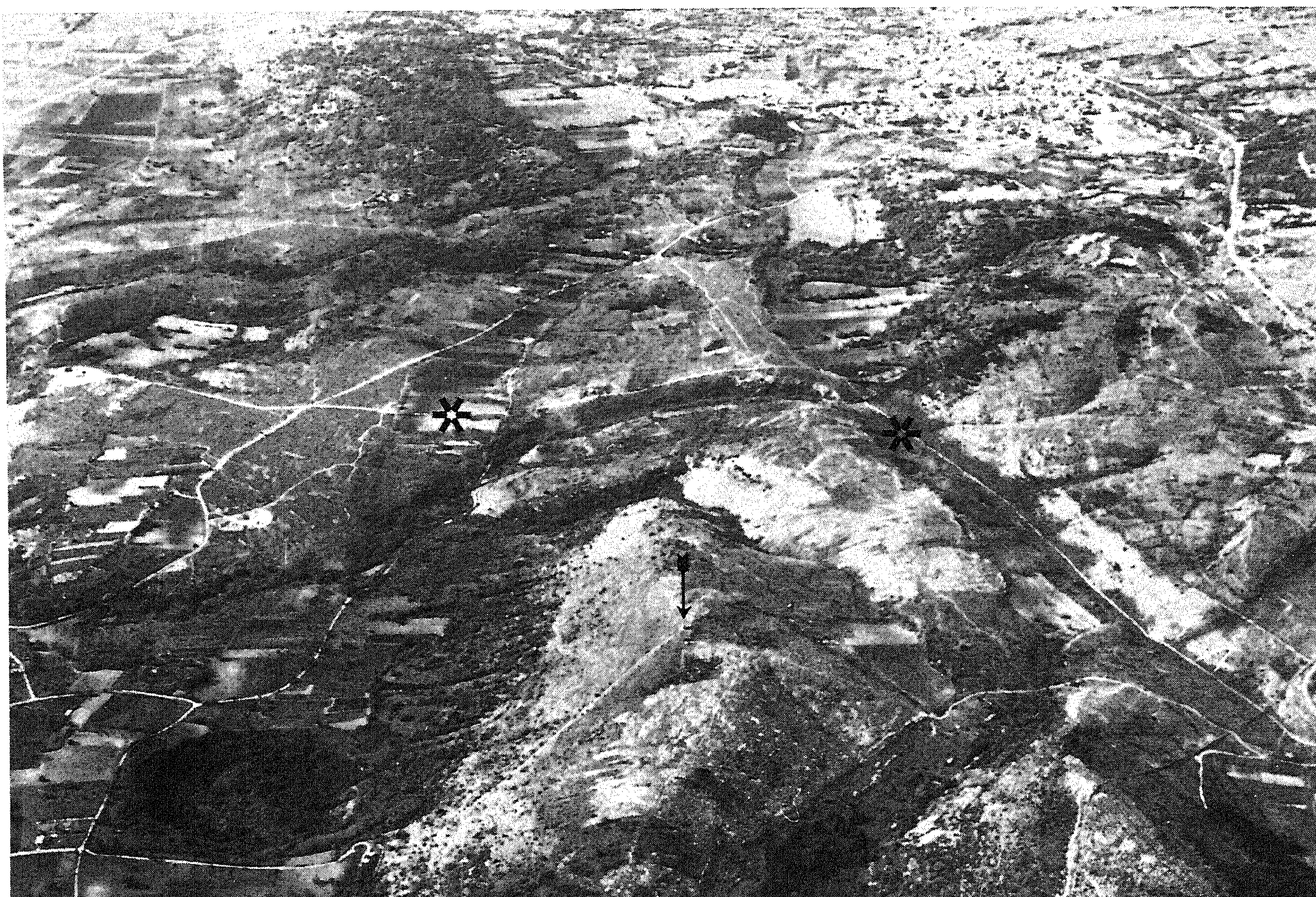
Fig. 12 - Veduta aerea della zona comprendente le due depressioni allungate coperte dai sedimenti 3 (indicate con asterischi), a N e a SW del colle sul quale sorge la chiesa di Santa Croce (a N di S. Demetrio ne' Vestini, indicata con la freccia); queste depressioni corrispondono alle faglie 2 e 3 della tavola 1 (rispettivamente a destra ed a sinistra nella foto).
