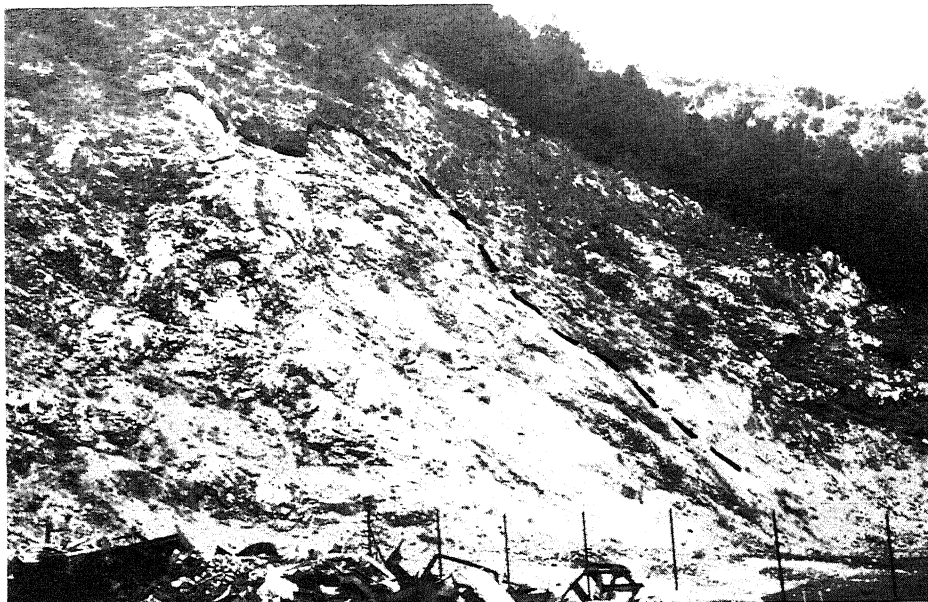
Fig. 4 - Importante piano di faglia distensivo a direzione N321°/46°, visibile in alcune cave di prestito lungo il bordo nord-orientale del Monte Soratte (Staz. 2).
