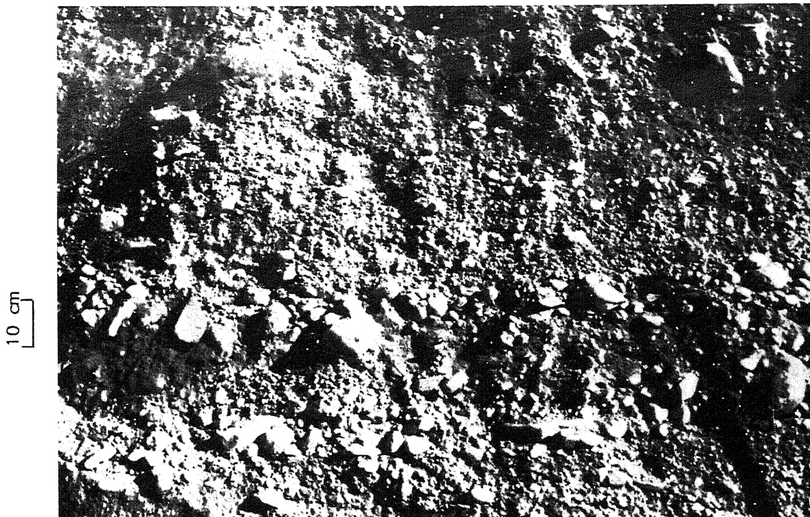
Fig. 9 - Ghiaie sabbiose a stratificazione orizzontale discontinua. Unità 4, parte superiore. Clast-supported sandy gravel with discontinuous horizontal bedding. Upper part of unit 4.
