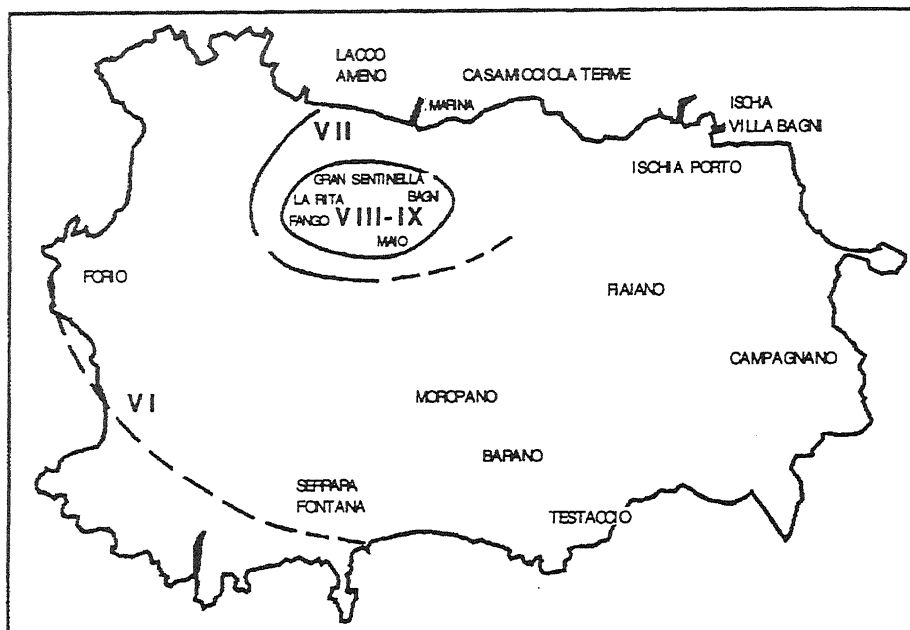
Fig. 2 - Campo macrosismico del terremoto del 2 febbraio 1828 che mostra una ristretta area epicentrale di VIII-IX MCS. In direzione Nord in corrispondenza di Marina di Casamicciola è registrato un crollo dell'intensità di almeno due gradi, in meno di un chilometro; una forte attenuazione degli effetti si registra, inoltre, nella parte orientale dell'isola.
